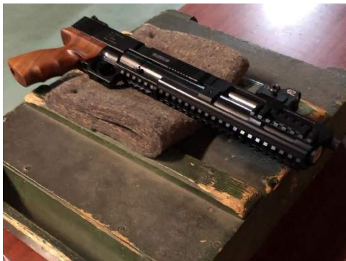
Оружие компании КАМПО калибр 5.5мм. мощность 3Дж.
